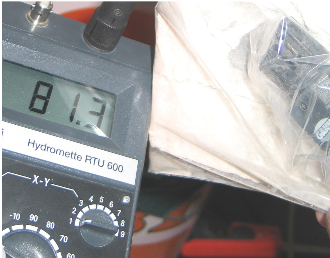
Abb. 3: Orientierende vergleichende (Bauteil-) Feuchtemessungen an einer aus einer (Fuß-) Bodenkonstruktion entnommenen Trittschalldämmung
