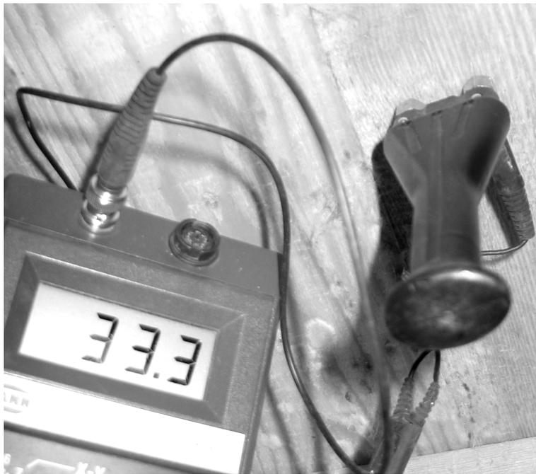
Abb. 3: Nasse und (schimmelpilzartig) verfärbte Dachschalung ohne nennenswerte(n) Fugenanteil(e) (in einer nicht belüfteten Dachkonstruktion)
